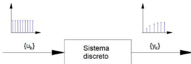
Figura 2.23: Representación de un sistema discreto.
